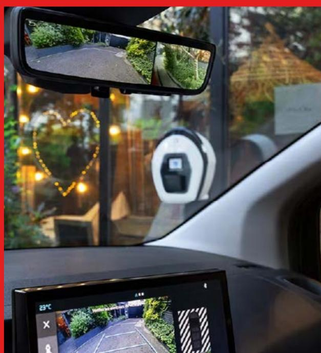
Conçu pour relever les défis spécifiques à la conduite d'un fourgon, le système repose sur deux caméras qui garantissent une visibilité complète, éliminant virtuellement les angles morts, que ce soit en circulation ou lors des manœuvres de stationnement.
